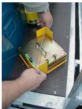
Retirer l'écrou papillon de l'axe de maintien des plaques
