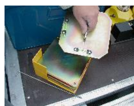
Retirer la plaque à niveaux et les plaques d'ancrage
